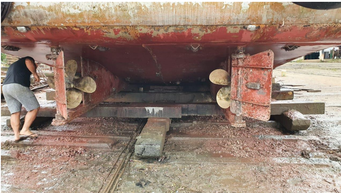
Figura 4 – Imagem de popa do rebocador/empurrador Hidrosub II, com a presença de bioincrustação.
