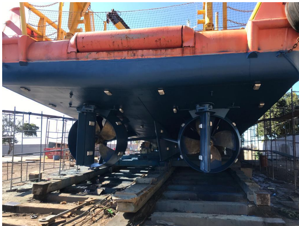
Figura 8 – Imagem dos propulsores do DRS Ipanema, após a raspagem da bioincrustação.
