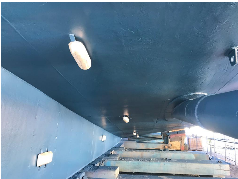
Figura 7 – Imagem do costado por bombordo da limpeza e pintura.
