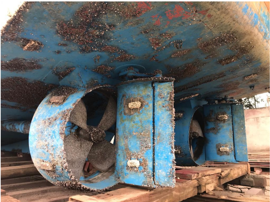
Figura 4 – Imagem de popa do rebocador/empurrador DRS Ipanema, com a presença de bioincrustação.
