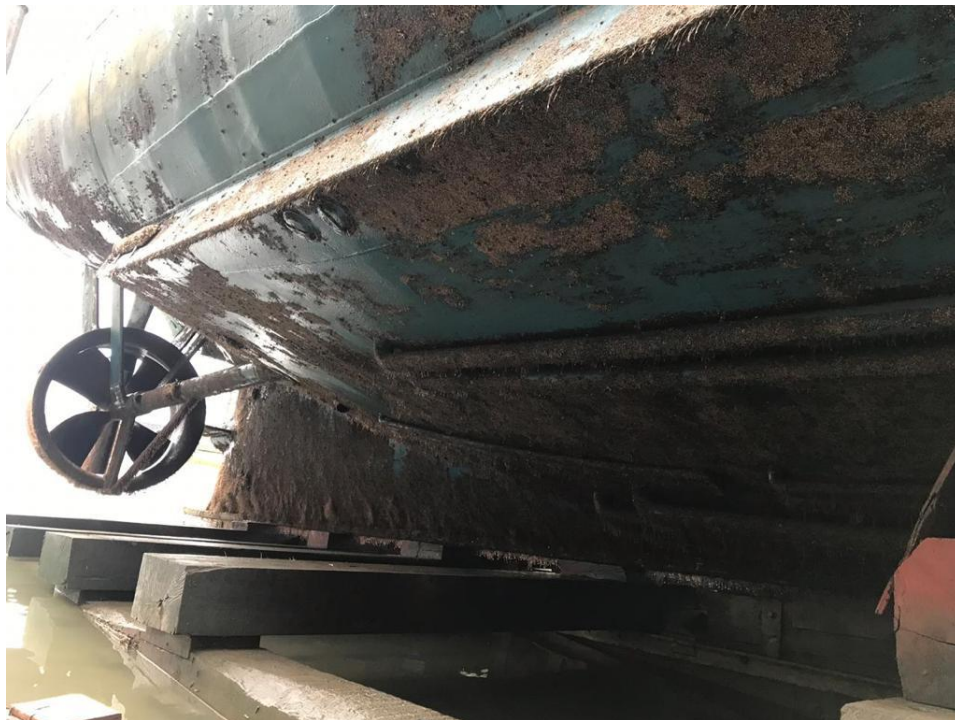
Figura 2 – Imagem da baixa diversidade de organismos na bioincrustação do rebocador/empurrador DRS Deep Sea, com destaque na presença de cirripédios e algas.
