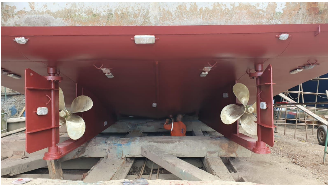
Figura 8 – Imagem dos propulsores do Hidrosub II, após a raspagem da bioincrustação.
