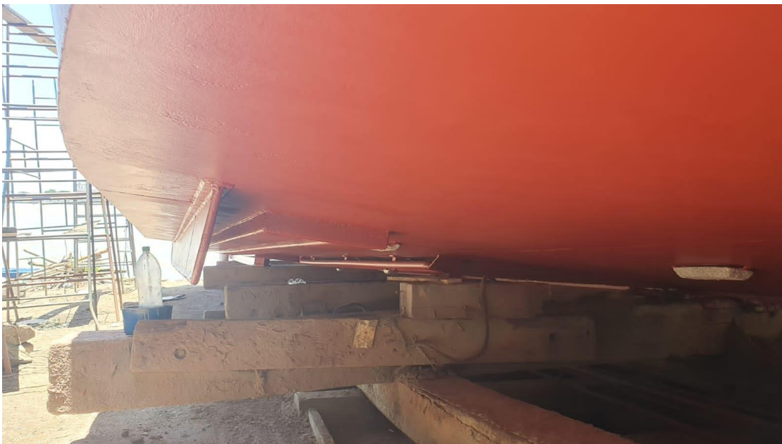
Figura 6 – Imagem do costado de Boreste do processo de limpeza e pintura.
